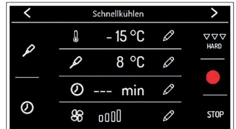
Temperaturgesteuertes Schnellkühlen oder Schockfrostern
